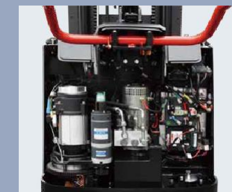
Il cofano motore può essere aperto completamente: tutte le componenti ed i pezzi risultano visibili al primo sguardo, aspetto molto utile per la manutenzione dell'intera macchina
