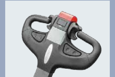
Il timone modulare semplice, affidabile e con un design accattivante. Tutte le sue parti possono essere sostituite singolarmente e tutte le operazioni di guida possono essere fatte con una sola mano.
