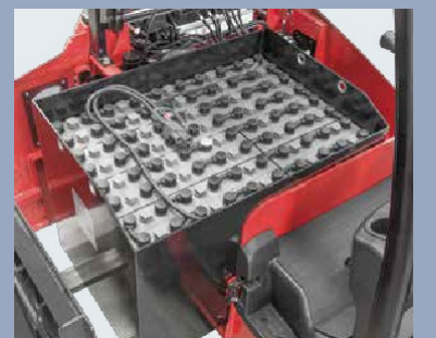
L'estrazione laterale della batteria tramite rullo offre una soluzione rapida, semplice e sicura per l'operatore
