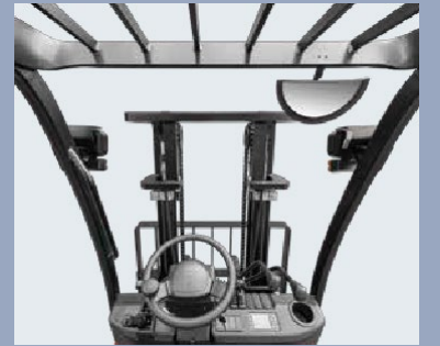
Il nuovo albero progettato e il grande tetto in acciaio aperto offrono una visibilità eccellente, inoltre possono ridurre il rischio di incidenti
