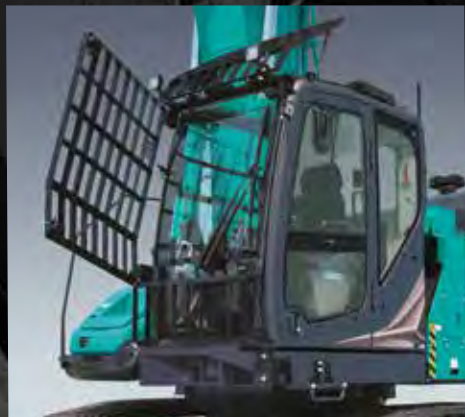
Protezione cabina ad apertura/chiusura facile da pulire (finestrino superiore-frontale e tettuccio)
