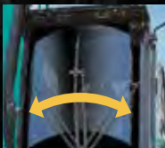
Area di spazzolamento del tergicristallo anteriore del 36% più ampia (rispetto alla cabina standard)
