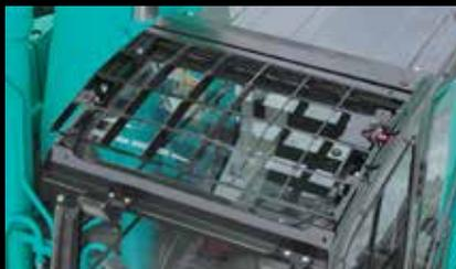
Protezione del tettuccio cabina a standard OPG
