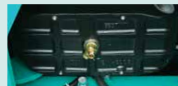
La valvola di scarico rapido dell'olio motore può essere ruotata senza attrezzi.
