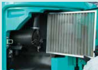
Filtro iNDr/serbatoio del radiatore/ filtro dell'aria
