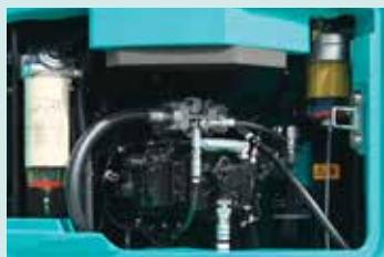
Filtro del carburante con separatore dell'acqua integrato
