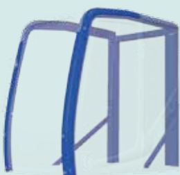
Protezione sul tettuccio di livello II (conforme a ISO10262)
