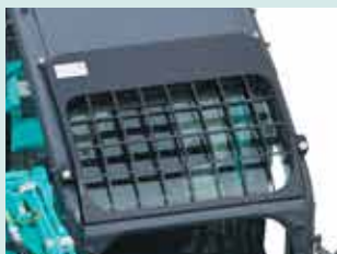
Protezione sul tettuccio di livello II (conforme a ISO10262)
