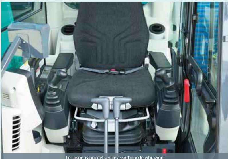
Le sospensioni del sedile assorbono le vibrazioni
