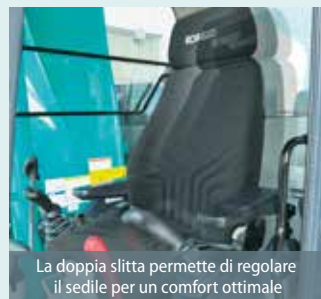
Le sospensioni del sedile assorbono le vibrazioni
