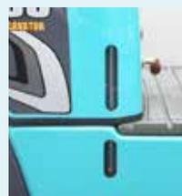
Indicatore sul serbatoio del carburante per l'immediata visibilità del livello di carburante.
