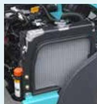
Radiatore in alluminio resistente alla corrosione.
