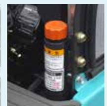
Olio idraulico a lunga durata con ciclo di cambio ogni 1000 ore (la foto mostra l'apertura di riempimento dell'olio idraulico).
