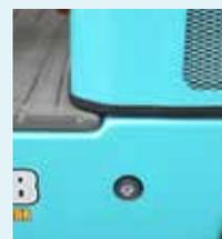
Indicatore sul serbatoio dell'olio idraulico facilmente controllabile.
