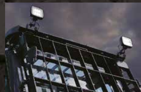
Tetto della cabina (2 luci)
