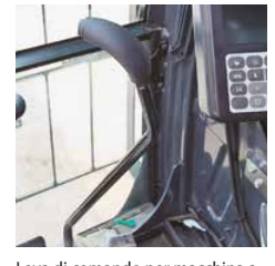
Leva di comando per macchina a specifiche per demolizioni a braccio High Reach in 4 segmenti installata nell'area per i piedi.
