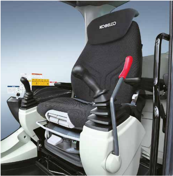
Sedile a sospensioni pneumatiche con supporto per schiena e collo, per ridurre la fatica
